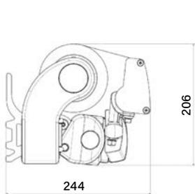
Instalación en la pared (en mm.)
