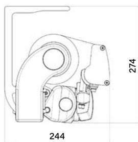
Instalación en el techo (en mm.)
